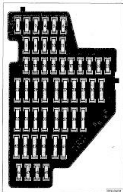
Rys. 43. Bezpieczniki w skrzynce w tablicy przyrządów
